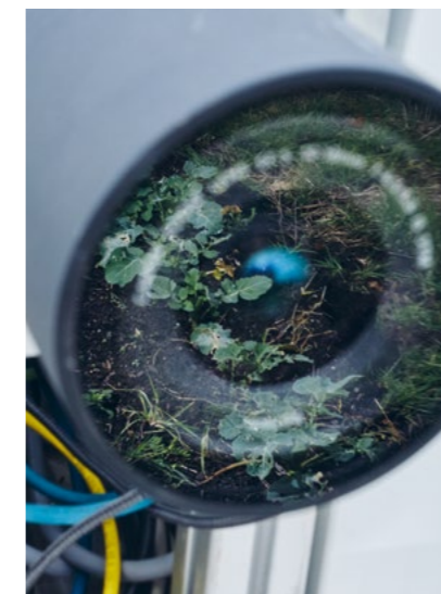
Mit verschiedenen Kameras, darunter Stereo-, Laser- und Wärmekameras, erstellt der Agrarroboter detaillierte Daten über den Zustand der Pflanzen.
